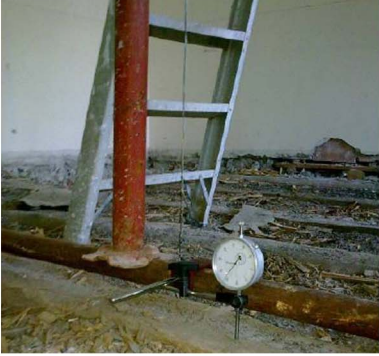
Verifica della freccia delle travi durante lo svuotamento, svuotamento meccanico, strutture lignee portate a nudo.
