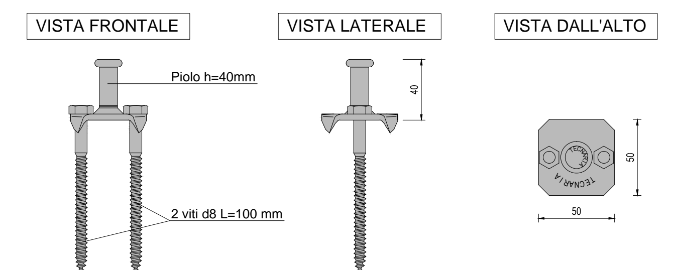
PARTICOLARE CONNETTORE - CTL BASE 12/40 (o similare)
